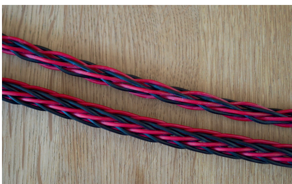
Das Kimber 4PR (oben) kommt je Plus/Minus-Pol mit vier Adern, das 8PR (unten) mit acht
